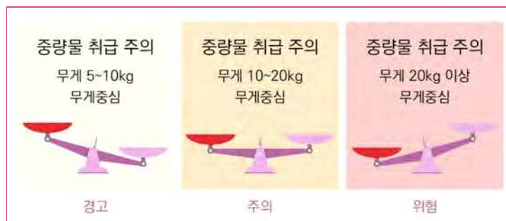
그림 8 중량물 취급주의 표시장치
