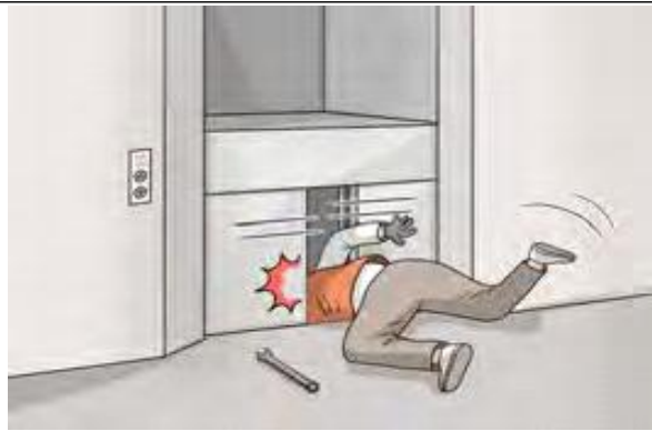
승강기 비전문가의 임의 수리·조작으로 불시 작동에 인한 끼임 및 떨어짐
